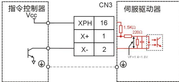
• YPH(17脚)、Y+(14脚)、Y-(15脚)的接线与XPH、X+、X-相同。
