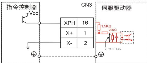
• YPH(17脚)、Y+(14脚)、Y-(15脚)的接线与XPH、X+、X-相同。
