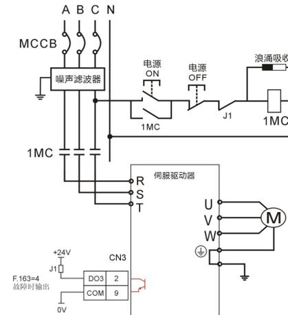
MCCB: 空气开关      1MC: 交流接触器      J1 : 继电器
