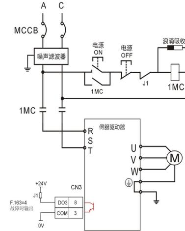
MCCB: 空气开关      1MC: 交流接触器      J1 : 继电器
