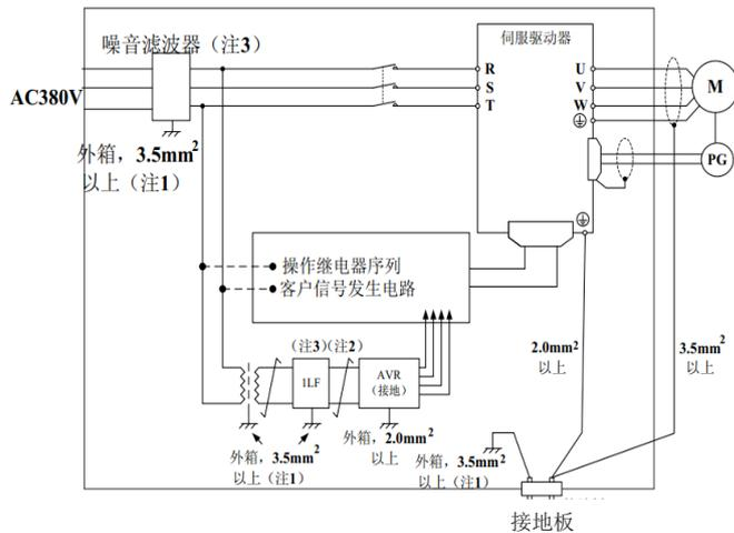
注1: 用于接地的外箱连接电线请尽可能使用  $3.5\text{mm}^2$  以上的粗线 (编织铜线比较合适)。
