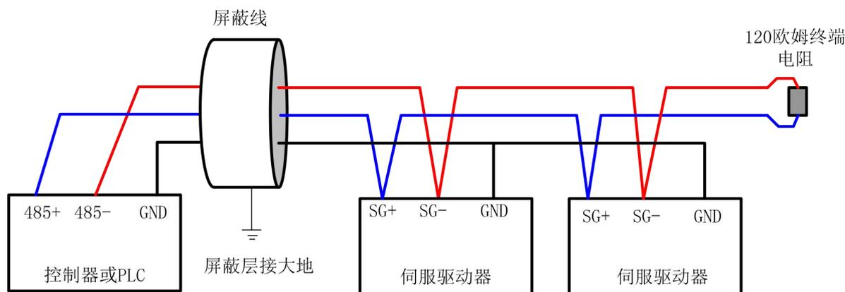
E 结构监控端口引脚分配及定义
