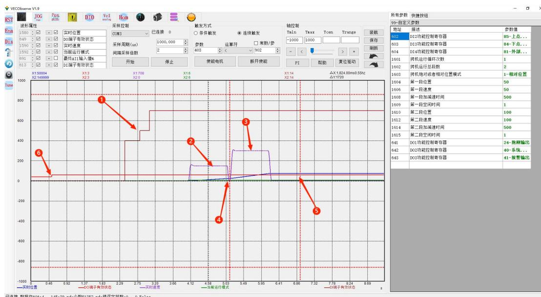
1. 在 INFn.84-下点动与 INFn.85-上点动同时有效的状态下, 触发 INFn.81-外部急停输入, 使系统处于拷机模式。
